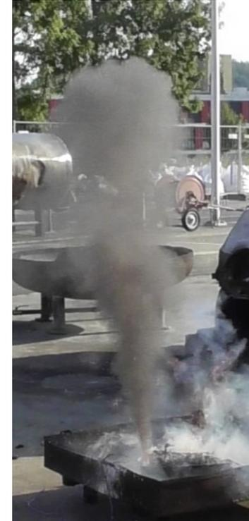
Abbildung 2.5: Ablauf einer thermisch durchgehenden LIZ Lithium-Ionen-Zelle
