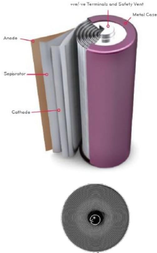
Die **zylindrische Zelle** ist die am weitesten verbreitete Bauform von Akkuzellen. Ein Standard ist die 18650-Zelle, die 18 mm im Durchmesser und 65 mm in der Höhe misst. Sie ist mechanisch relativ stabil, denn sie verfügt über eine Metallhülle.
