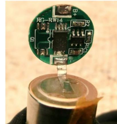
**BMS** = Batterieüberwachungselektronik (Steuerung und Überwachung der Batterie)
